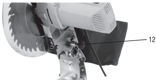
Figura 4 – Procedimento para levantar o cabeçote
