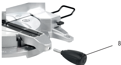
Figura 2 – Montagem da alavanca de ajuste da mesa
